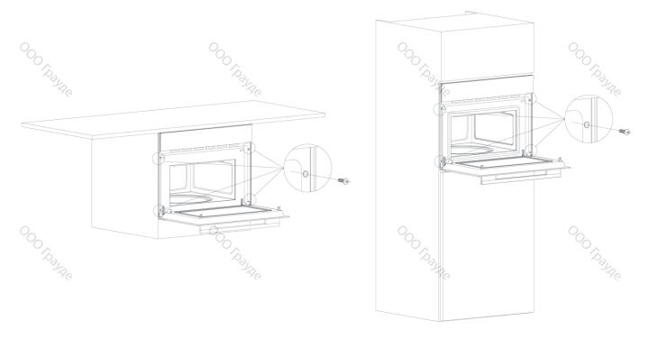
Примечание: При монтаже и перемещении запрещается поднимать прибор за ручку дверцы.
