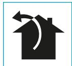
Tässä versiossa savut ja höyryt johdetaan ulkotilaan poistoputken kautta. Tätä varten liesituulettimen ilmanpoistoliitos on liitettyvä putkeen, jossa on ulkoinen poistaukko.
