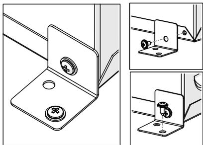
2b. Si le produit est installé dans un manteau sur mesure, ou dans une ouverture existante, fixer le foyer en introduisant une vis adaptée soit dans l'orifice avant, soit dans l'orifice arrière de la face intérieure du foyer, selon l'emplacement le mieux adapté pour l'installation.
