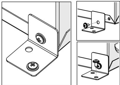
26. При установке камина в кожух, имеющийся у клиента, или существующую нишу, закрепите его, вставив соответствующий винт либо через переднее, либо через заднее отверстие во внутренней поверхности камина. Это зависит от того, какое место наиболее подходит для установки.
