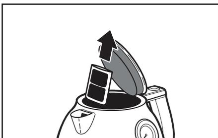
**Удаление фильтра:** Откройте крышку. Возьмитесь за верхнюю часть фильтра, находящегося за носиком чайника, и извлеките его.
