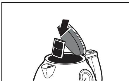
**Установка фильтра:** Фильтр находится за носиком, во внутренней части электрочайника. Откройте крышку. Установите фильтр в пазы внутри носика чайника так, чтобы изгиб фильтра совпал с изгибом носика.
