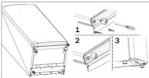
Слегка наклоните прибор назад и зафиксируйте его в этом положении. С помощью винта закрепите прилагаемую предохранительную ножку в специальном отверстии с нижней стороны двери.
