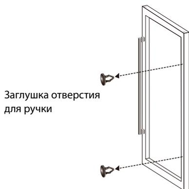
**8.** Осторожно потяните дверную прокладку в сторону, чтобы открыть винты ручки (2 шт.) с левой стороны дверцы. Отвинтите ее крестовой отверткой и снимите ручку (оставьте шайбы на месте).
