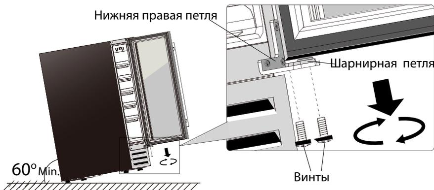
2. Осторожно, стараясь не поцарапать, снимите дверцу с верхней правой петли. Выньте шарнирную петлю из отверстия дверной петли.
