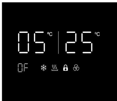
Когда панель управления прибора разблокирована и выбрана, на дисплее индикации температуры будет отображаться установленная в приборе температура, и также текущая температура - когда панель управления заблокирована.
