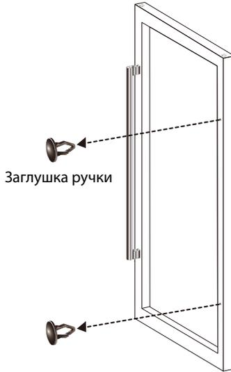
6. Осторожно потяните прокладку дверцы в сторону для того, чтобы открыть винты ручки (2 шт.) с левой стороны дверцы. Отвинтите их крестовой отверткой и снимите ручку (оставьте шайбы на месте).
