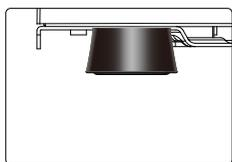
о Наклоните прибор примерно на 60°, чтобы открыть доступ к регулируемым ножкам.
