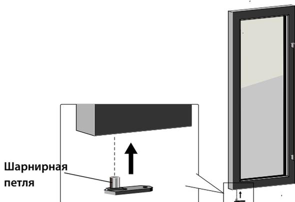
**12.** Установите дверцу со стороны левой петли, затянув поворотную петлю 2 винтами.
