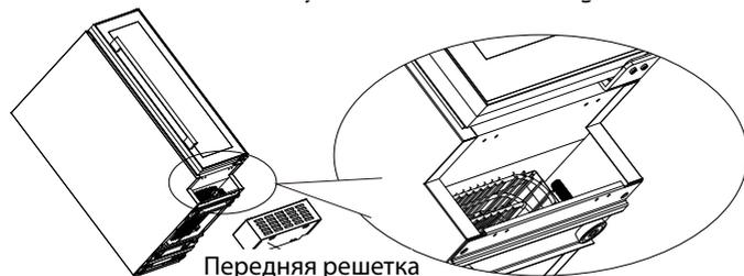
2. Установите переднюю решетку, плотно закрутив 4 самореза (ST4.2x10) с помощью крестовой отвертки;
