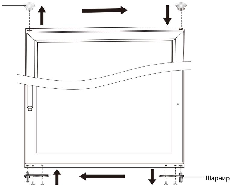
**3.** Снимите заглушку с нижнего шарнира, осторожно поддев ее небольшой плоской отверткой. Снимите нижнюю петлю, открутив винт с шестигранной головкой (4 шт.). Открутите винт с полукруглой головкой (4 шт.) внизу слева. Затем переместите нижний шарнир в нижнюю левую сторону и плотно закрутите его винтами с шестигранной головкой (4 шт.). Переместите винт с цилиндрической головкой (4 шт.) в нижнюю правую сторону и прикрутите его.
