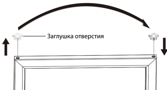
**7.** Снимите заглушку отверстия для ручки (2 шт.) с правой стороны дверцы, осторожно поддев ее небольшой плоской отверткой.
